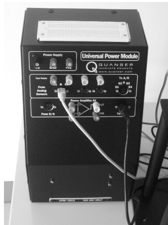
図 7 パワーアンプ
