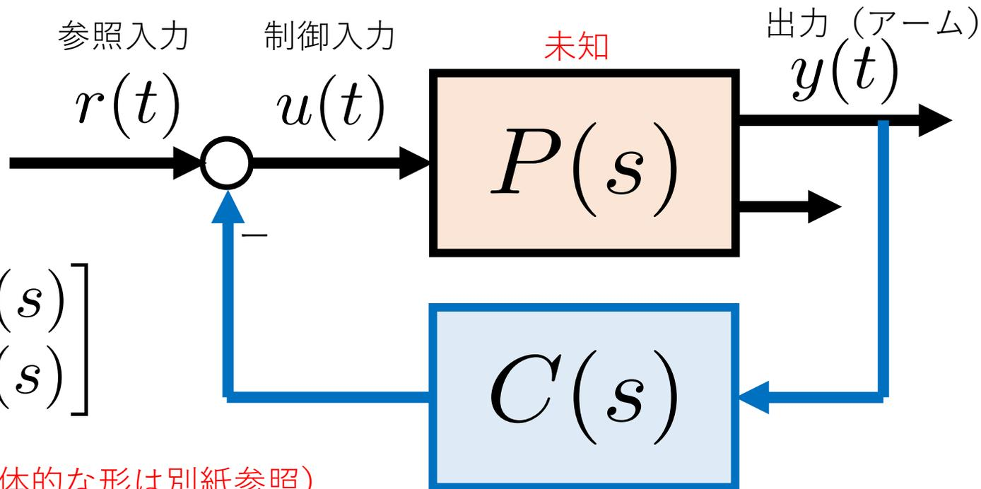
$$P(s) = \begin{bmatrix} P_{\text{arm}}(s) \\ P_{\text{link}}(s) \end{bmatrix}$$
